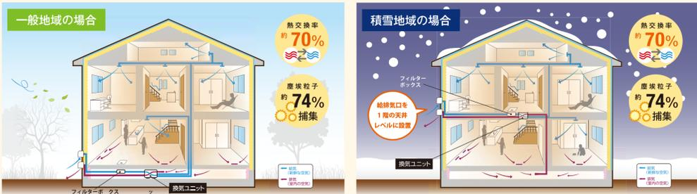
給排気に機械動力を使用する「第1種換気」と熱交換ユニット(エレメント)を通った空気を建物内に取り入れる「全熱交換式」を採用した24時間換気です。
